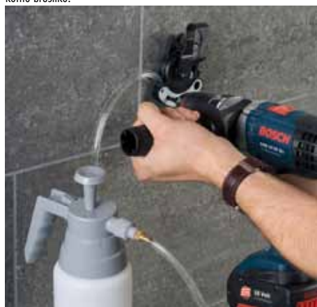
Mokro vrtanje z XH Ceramics diamantnim svedom s pomočjo šablone in tlačne posode za hlajenje.
