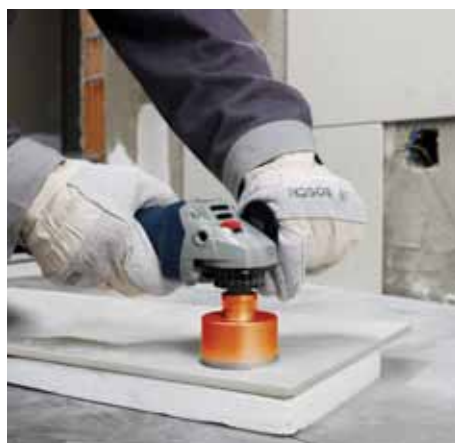
Suho vrtanje s Speed Ceramics diamantno krono priključeno na kotno brusilko.
