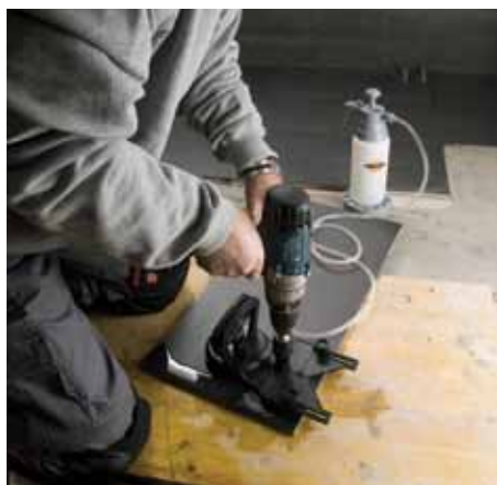
Mokro vrtanje z XH Ceramics diamantno krono s pomočjo šablone in tlačne posode za hlajenje.
